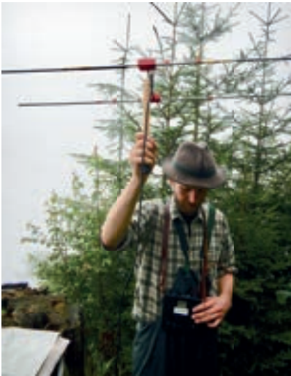
Die VHF-Technologie, bestehend aus einer VHF-Antenne und einer im GPS-Halsbandsystem integrierten VHF-Einheit, ermöglichte die Lokalisation von Rotwild im Gelände.
