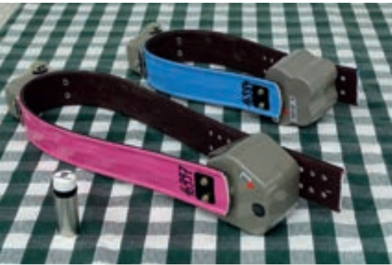
GPS-Halsbandsystem, bestehend aus je einem Senderhalsband und einer Pansensonde („Schlucksonde“).
