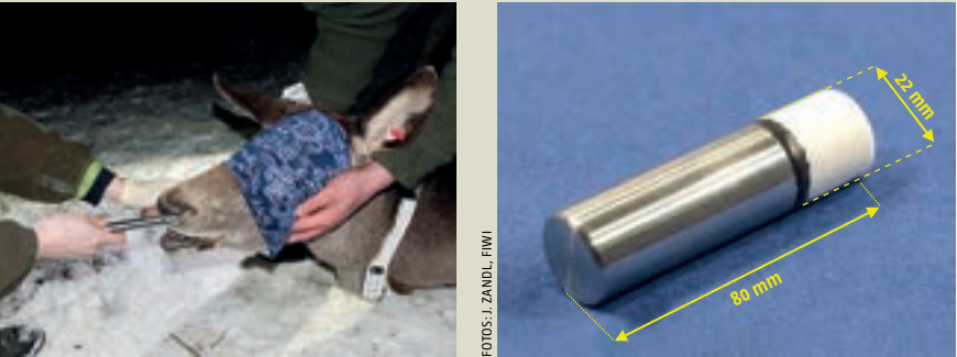
Abb. 1: Zur Messung der inneren Körpertemperatur und Pulsrate von Rotwild kamen solche „Schlucksonden“ zum Einsatz.
